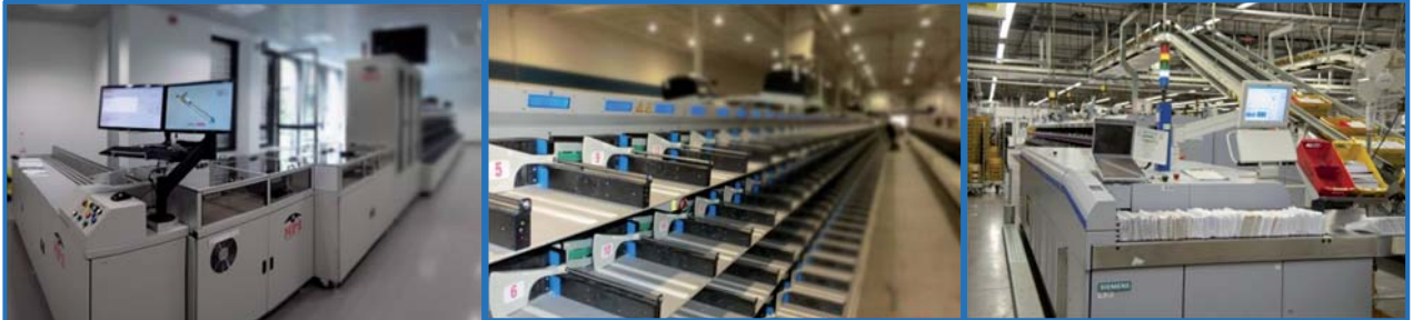
Briefsortiermaschine für Standardbriefe, rechts werden die Briefe aus den ankommenden Kästen per Hand in das Magazin der Maschine gegeben
